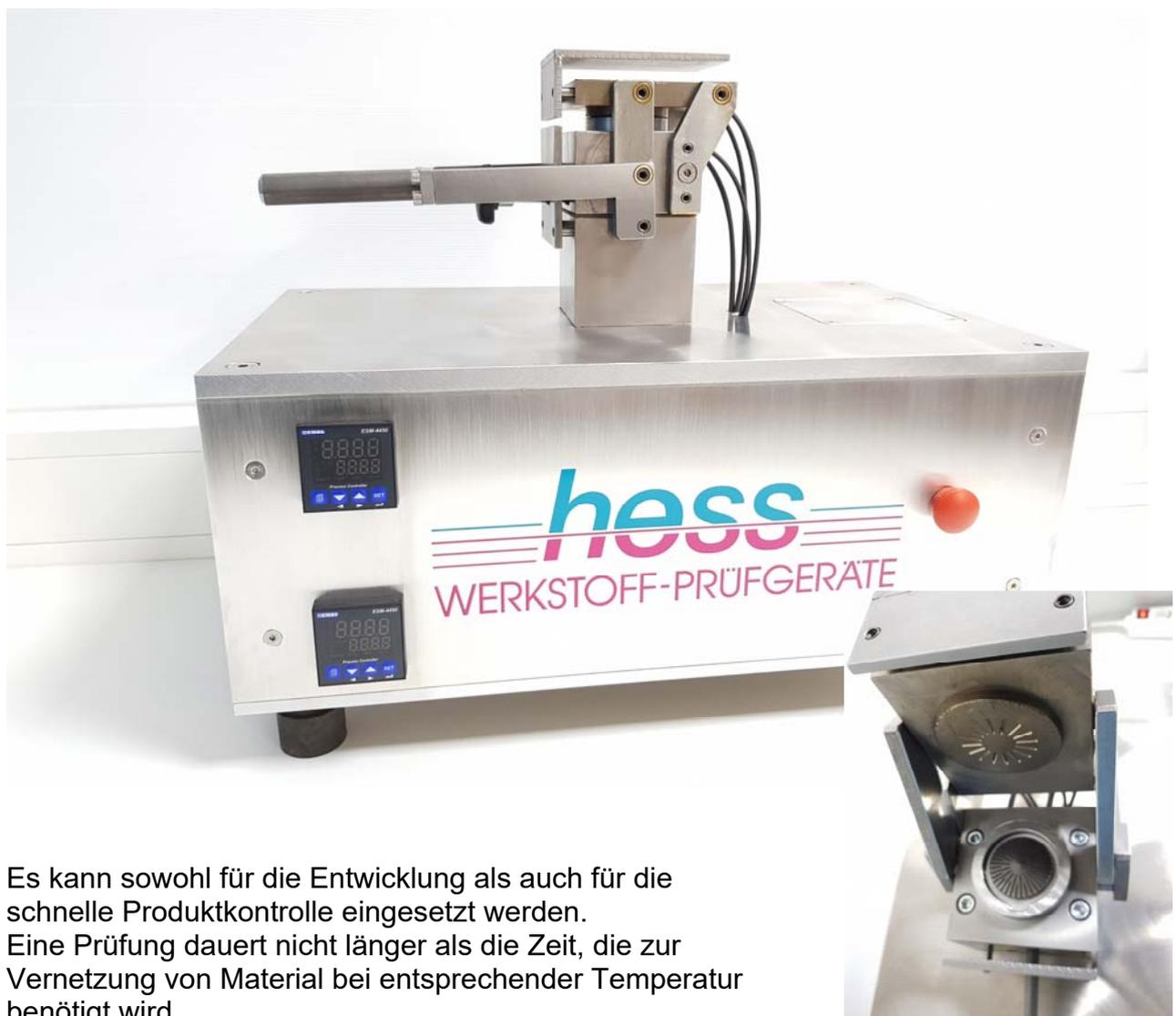
Es kann sowohl für die Entwicklung als auch für die schnelle Produktkontrolle eingesetzt werden. Eine Prüfung dauert nicht länger als die Zeit, die zur Vernetzung von Material bei entsprechender Temperatur benötigt wird.
