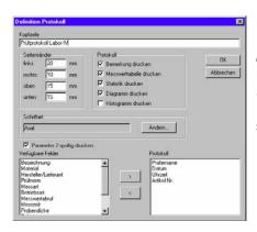
Das Prüfprotokoll kann frei definiert werden (natürlich auch für Etikettendruck). Über die Seitenansicht kann vor dem Ausdruck die Aufteilung kontrolliert werden. Die Größe für Diagramm und Histogramm wird automatisch auf die Blattgröße angepasst. Die Schriftart und –größe kann frei gewählt werden. Ebenso die Prüfparameter, die auf dem Protokoll mit ausgegeben werden sollen.
