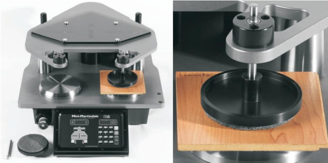
Unser MINI-Martindale kann entsprechend der **DIN EN 16094** eingesetzt werden zur **Bestimmung der Mikrokratzbeständigkeit von Holz, Laminat, Kunststoff, lackierten Oberflächen und Möbeloberflächen**. Es eignet sich ebenfalls zur **Bestimmung der Beständigkeit gegen Vielfachzerkratzung und Aufpolieren**.
