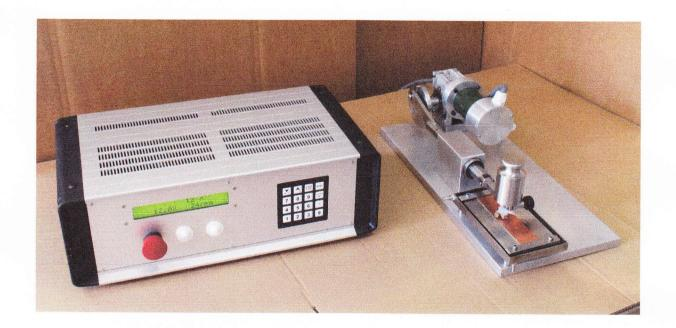
Vorrichtung zur Bestimmung der Beständigkeit gegen Lösemittel (Reibtest)
