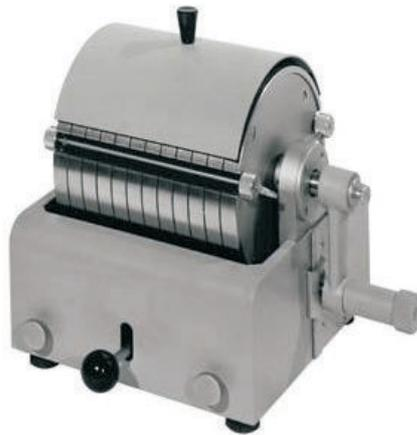
Der Folien und Papierstreifenschneider HSF wurde entwickelt um aus einem DIN A 4 großen Folien oder Papiereite bis zu 10 Stück parallele Streifen in einem Arbeitsgang herzustellen. Diese Streifen werden für weitgehende Festigkeitsuntersuchungen ( Dehnung, Zugfestigkeit, E-Modul) gemäß der internationalen Normen benötigt.
