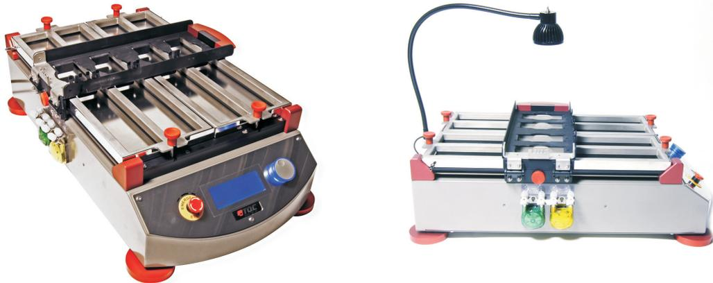
Viele Normen erfordern die Durchführung eines trockenen oder nassen Abrieb- und Scheuertestes, um die Qualität der Beschichtung zu bestimmen. Wie z. B. in EN13300. Diese Norm definiert eine Qualitäts-Ranking für die Innenbeschichtung bei Nassabrieb.
